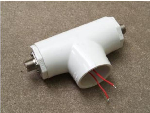
Fig. 11 - Masthead Tee Subassembly
